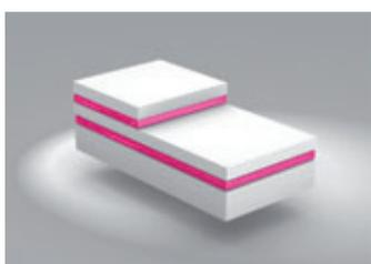
Для защиты граней склеенных гибких материалов при возможности излома необходимо дополнительно наклеить усиливающую **окантовку**.
