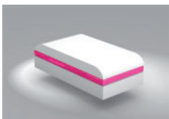
Еще одной возможностью к усилению клеевого соединения является **скругление граней**. Этим достигается уменьшение площади нагрузки.
