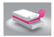
Клеевое соединение, подвергающееся нагрузкам на излом очень подвержено возможности повреждения. В этом случае действует только малая часть адгезивных связей.
