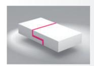
Еще более прочно ступенчатое косое соединение.
