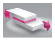
Аналогично и при нагрузке на сдвиг действующие силы распределены равномерно. Если склеивание проведено тщательно - такое соединение прочно
