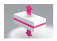
Склеенные материалы высоко устойчивы против нагрузок на разрыв. На всю поверхность силы действуют равномерно
