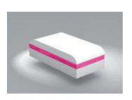
Еще одной возможностью к усилению клеевого соединения является **скругление граней.** Этим достигается уменшение площади нагрузки.
